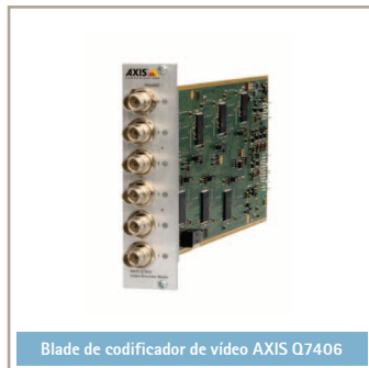
Um exemplo de blade de codificador de vídeo com seis canais.
