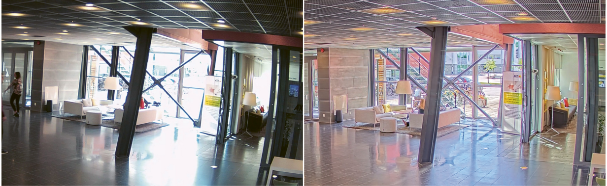
Figure 3. 강한 역광 상태의 실내 장면. WDR 기능이 없는 카메라(왼쪽)와 Forensic WDR 기능이 있는 Axis 카메라(오른쪽) 간 비교.
