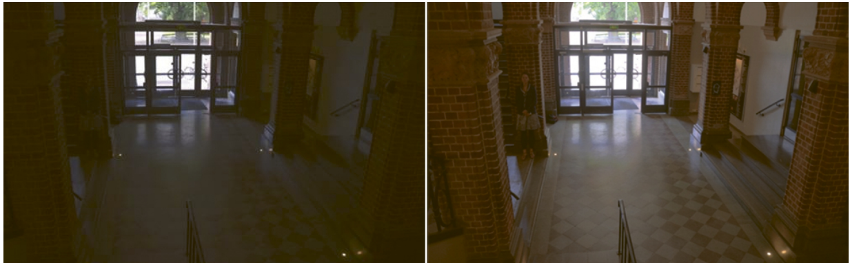
Figure 4. 다른 dB 값의 카메라로 캡처한 역광 상태 실내. 예상과 달리 오른쪽 이미지가 왼쪽 이미지보다 지정된 dB 값이 낮은 카메라로 촬영한 이미지입니다.
