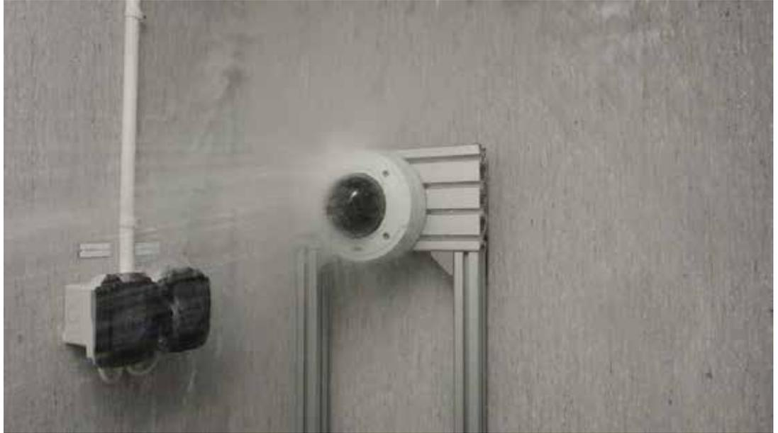
図4: カメラの防水性試験
