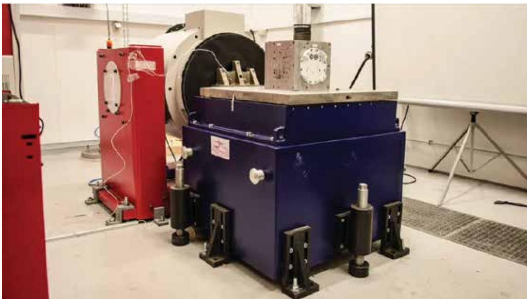
図5: 堅牢性試験に使用する装置
