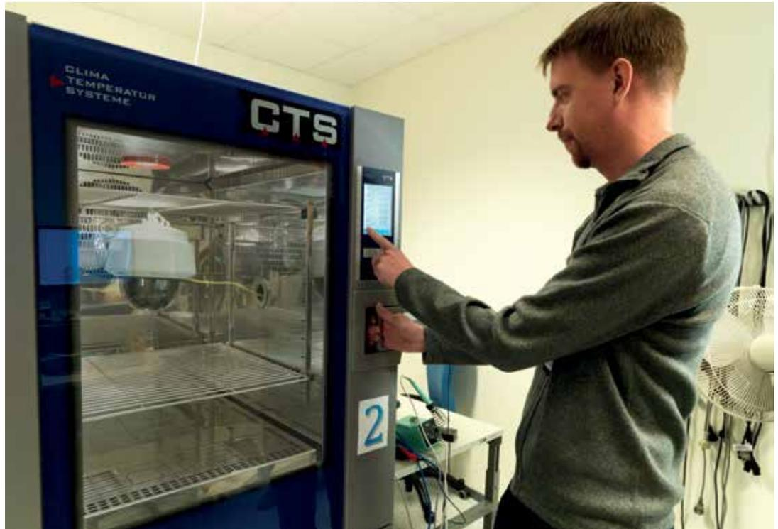
図8: 人工気候室で行う温度試験
