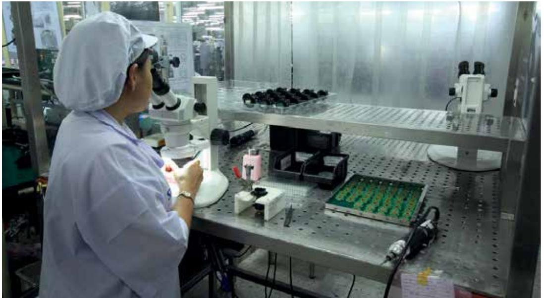
図2: センサーラボで行われる撮像素子試験
