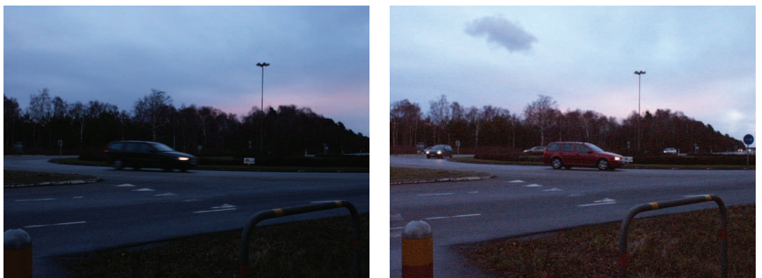
Figura 3. À esquerda, um ambiente com 500 lux e ganho baixo. À direita, um ambiente similar de 500 lux, mas com ganho alto. As imagens ilustram como o aumento do ganho amplifica o sinal do vídeo e torna a imagem mais clara, com o prejuízo de aumentar o ruído da imagem.
