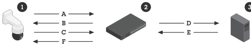
Figure 8. 온보딩 프로세스에 대한 더 자세한 설명. 보안 장치 ID를 위한 IEEE 802.1AR은 장치에 네트워크 액세스 권한을 부여하기 위해 RADIUS 서버(3)를 사용하여 IEEE 802.1X EAP 요청(EAP-TLS)을 통해 장치(1)를 식별하는 방법을 정의합니다.
