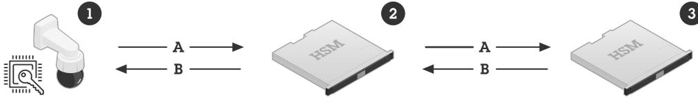
Figure 5. 제조 프로세스 중에 Axis 장치 ID를 공장 프로비저닝하기 위한 Axis IEEE 802.1AR 공개 키 인프라(PKI). 제품의 일련 번호가 포함된 인증서인 Axis 장치 ID(1)는 Axis 장치 ID 루트 CA(3)에서 서명한 Axis 장치 ID 중간 CA(2)에 의해 서명됩니다. 전용 하드웨어 보안 모듈(HSM)이 안전한 공장 프로비저닝에 사용됩니다.
