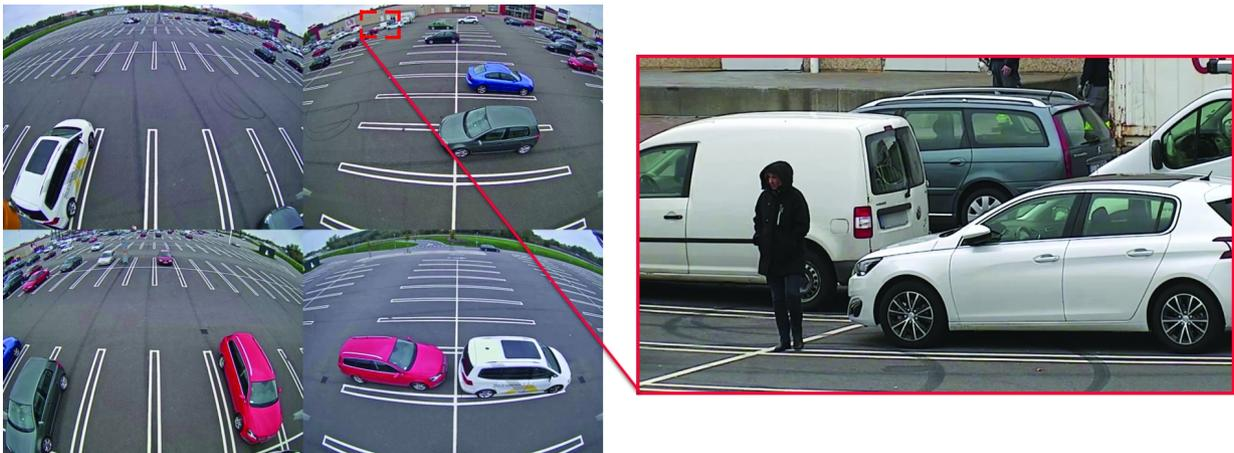
利用PTZ多方向摄像机的四画面360° 全景视图和PTZ变焦放大视图来监控停车场。
