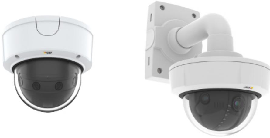
多传感器全景摄像机在一个外壳中安装了多个传感器和镜头。传感器的单个画面略有重叠，通过对齐后可提供连贯的详细180°全景概览。
