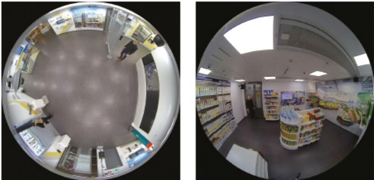
单传感器摄像机的圆形视图。吊装摄像机提供整个房间的完整概览（左）。墙装摄像机以适合观察人脸的角度提供概览（右）。
