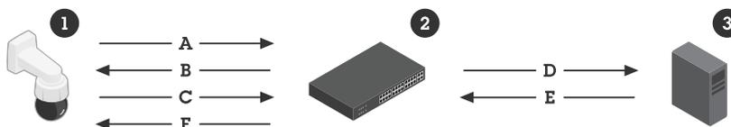
Figure 8. Descrição mais detalhada do processo de integração. O IEEE 802.1AR para identidade segura de dispositivo define um método para identificar um dispositivo (1) por meio de solicitações IEEE 802.1X EAP (EAP-TLS) usando um servidor RADIUS (3) para conceder acesso do dispositivo à rede.
