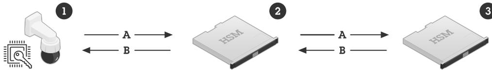
Figure 5. Infraestrutura de chave pública (PKI) IEEE 802.1AR da Axis, para provisionamento de fábrica da ID do dispositivo Axis durante o processo de manufatura. A ID do dispositivo Axis (1), que é um certificado que incorpora o número de série do produto, é assinado por uma ID do dispositivo Axis intermediária CA (2), que foi assinado pela raiz CA da ID do dispositivo Axis (3). Módulos de segurança de hardware (HSM) dedicados são usados para provisionamento seguro de fábrica.
