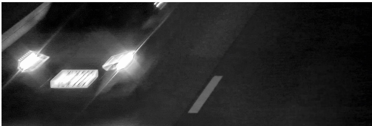
Figure 13. Изображение быстро движущегося автомобиля, снятое с выдержкой 1/30 с.
