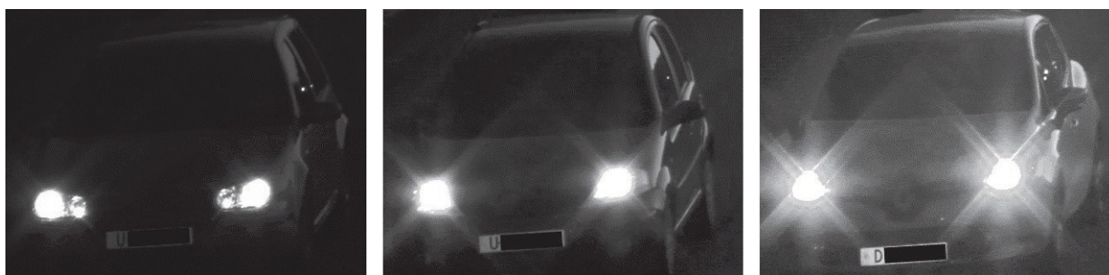
Figure 15. Регулировки цветокоррекции и локальной контрастности требуют поиска оптимального компромисса между яркостью и контрастностью номерного знака, с одной стороны, и шумностью и засветкой изображения – с другой.
