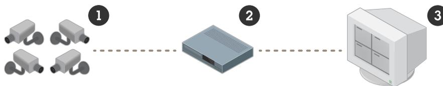
Figure 6. Sistema di sorveglianza con telecamere (1) analogiche collegate a un DVR (2), che comprende la funzionalità quad o multiplexer e supporta la registrazione in formato digitale.
