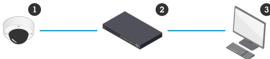
*Figure 11. Un sistema di rete vero e proprio, in cui il video acquisito dalle telecamere di rete (1) viene trasportato continuamente su una rete IP. Questo sistema sfrutta tutti i vantaggi della tecnologia digitale e offre una qualità d'immagine costante dalle telecamere all'utente in qualsiasi ubicazione, grazie a uno switch PoE (2) e a un computer con software di gestione video (3).*
