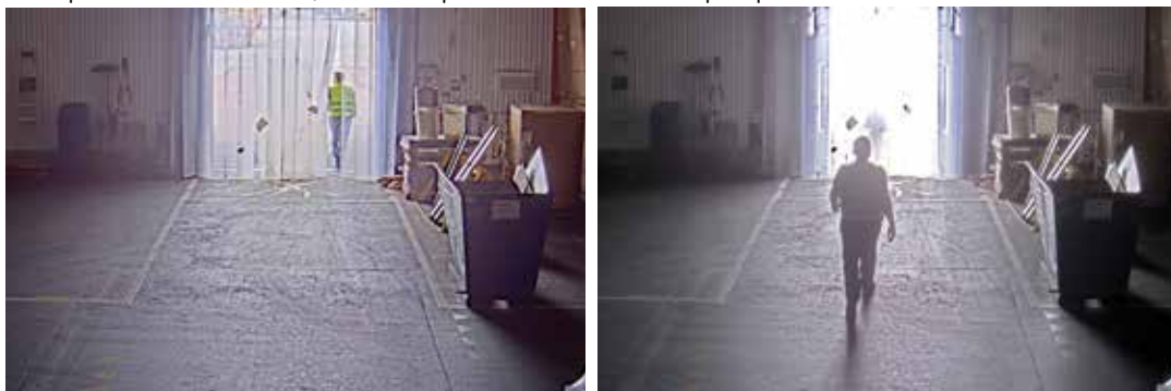
Изображение на ярком фоне с применением технологии WDR (слева) и без поддержки WDR (справа).
