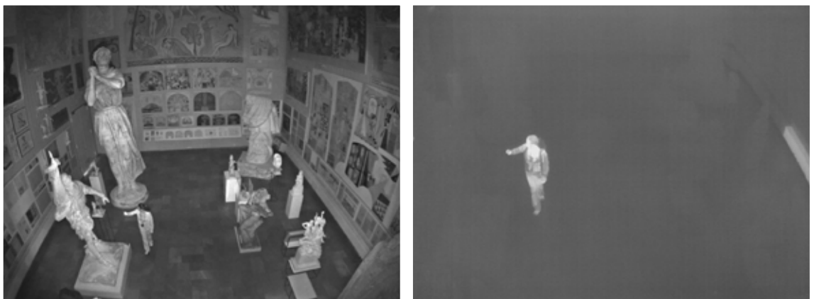
Рис. 4 и 5: Слева – изображение с камеры круглосуточного применения со встроенной ИК подсветкой, справа – изображение с тепловизионной камеры, регистрирующей пассивное тепловое излучение.
