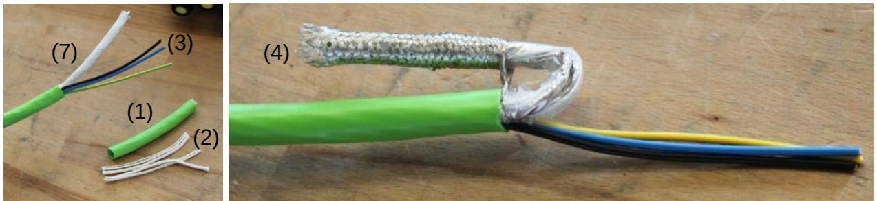
Abb. 2.2 – Abisoliertes Kabel und freigelegter Schirm
