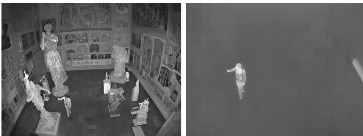
Figure 4. デイナイトカメラとサーマルカメラの比較画像 (いずれも暗闇で撮影)。
