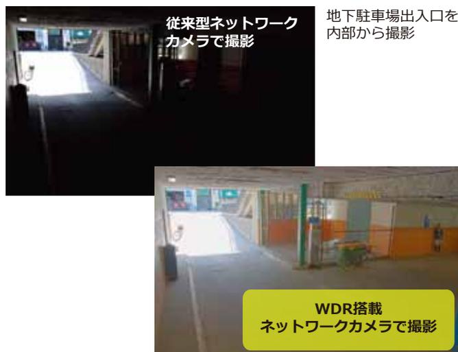
高度なアルゴリズム群を適用することでノイズレベルを下げ、画像信号を増大させることにより、シーンの詳細部分すべてを可能な限り最良の方法で表示します。
