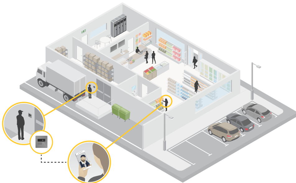
Figure 2. 이는 중소기업을 위한 일반적인 보안 구성입니다. 비디오 인터콤을 통해 직원은 고객을 방치하지 않고도 상품을 인수하고 방문자를 위해 도어를 열 수 있습니다.
