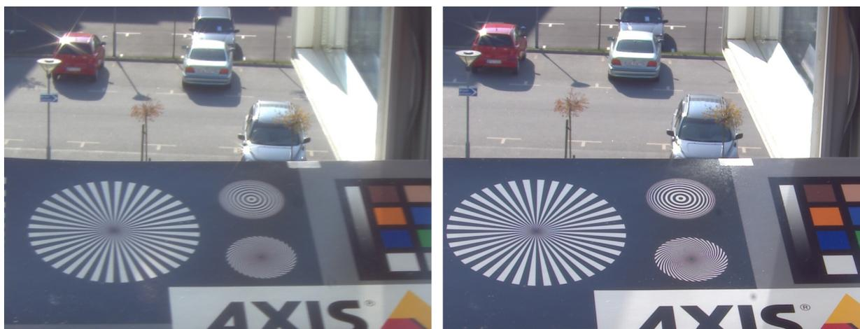
*La imagen de la izquierda se captó con una cámara que utiliza un objetivo con iris tipo DC. La imagen de la derecha se captó con una cámara que utiliza un objetivo con P-Iris y muestra una mayor nitidez que la imagen de la izquierda.*
