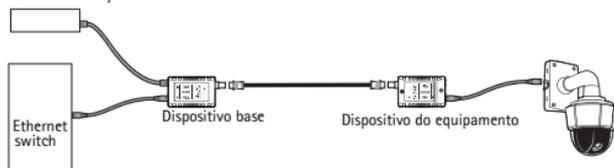
Exemplo 2 - Alimentação externa necessária quando usado com Switch não PoE
