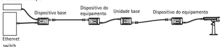
Exemplo 3 - Solução com alimentação PoE (Fonte de alimentação opcional necessária quando usado com cabos de baixa qualidade)
