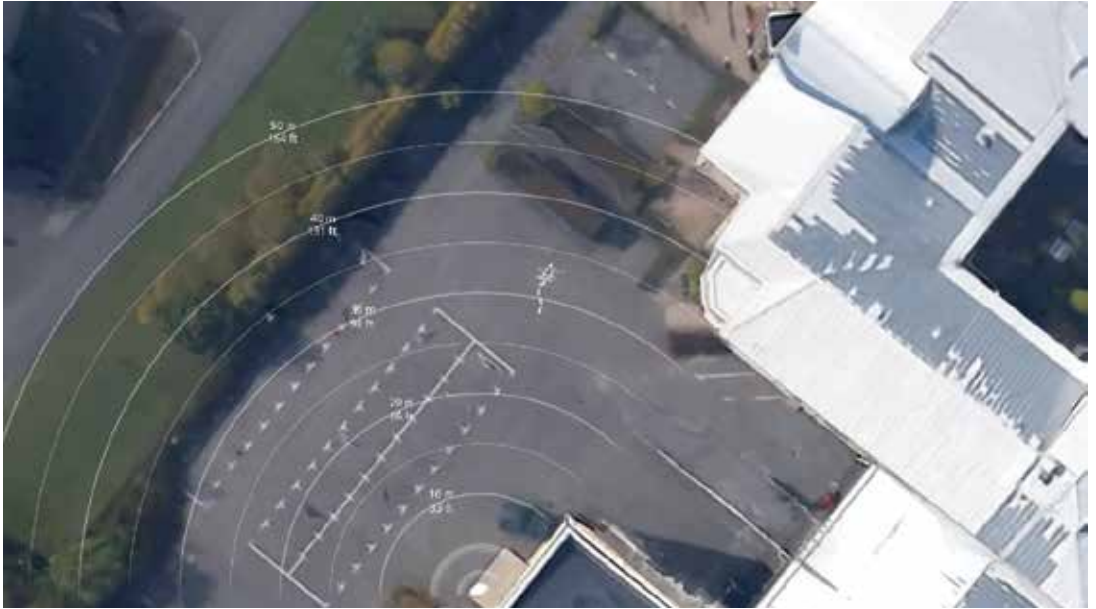
Figura 2. Una escena (desde arriba) monitorizada con el detector de radar en red AXIS D2050-VE, tal y como aparece en el interfaz del usuario cuando se combina con un mapa de referencia. El detector se montó en el edificio, en la parte inferior de la imagen. La flecha justo encima del centro de la imagen indica un objeto que está siguiendo el detector.
