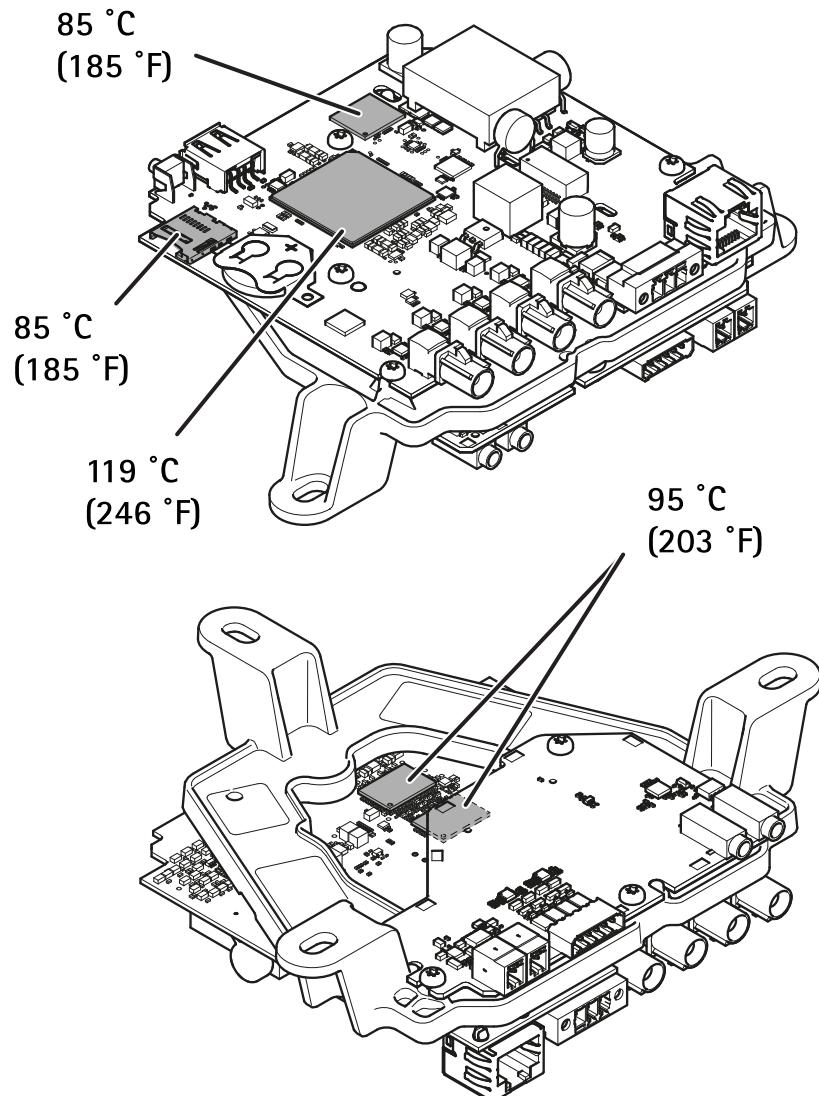
**Maximal zulässige Temperaturen.** Wenn die Umgebungstemperatur  $35^{\circ}\text{C}$  ( $95^{\circ}\text{F}$ ) oder höher beträgt, steigt die Temperatur der Komponenten und sie müssen gekühlt werden.
