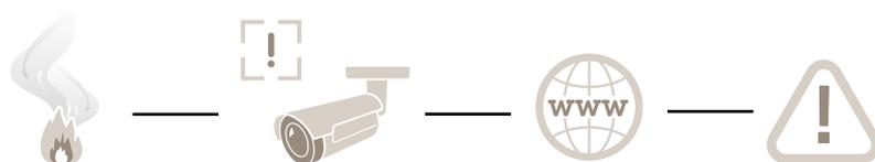
*Le feu est détecté par une caméra capable de déclencher de nombreux types d'actions par le réseau.*
