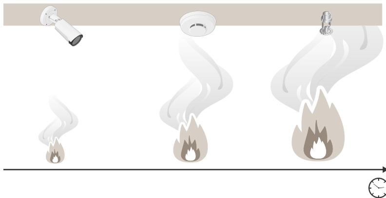
*La détection d'incendie déclenchée par la vidéo est plus réactive que les détecteurs de fumée traditionnels.*
