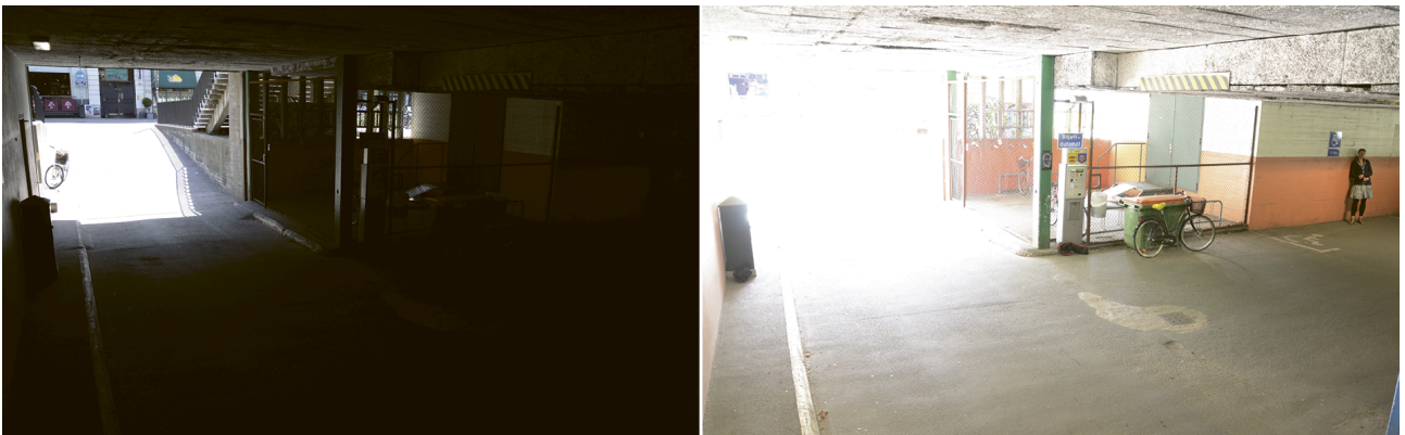
図 2.1 ダイナミックレンジが広い典型的な監視シーン: エントランスがあるパーキングガレージの屋内。この2つの画像は、異なる露出時間を使用して撮影されています。左側が露出時間の短い画像、右側が露出時間の長い画像です。
