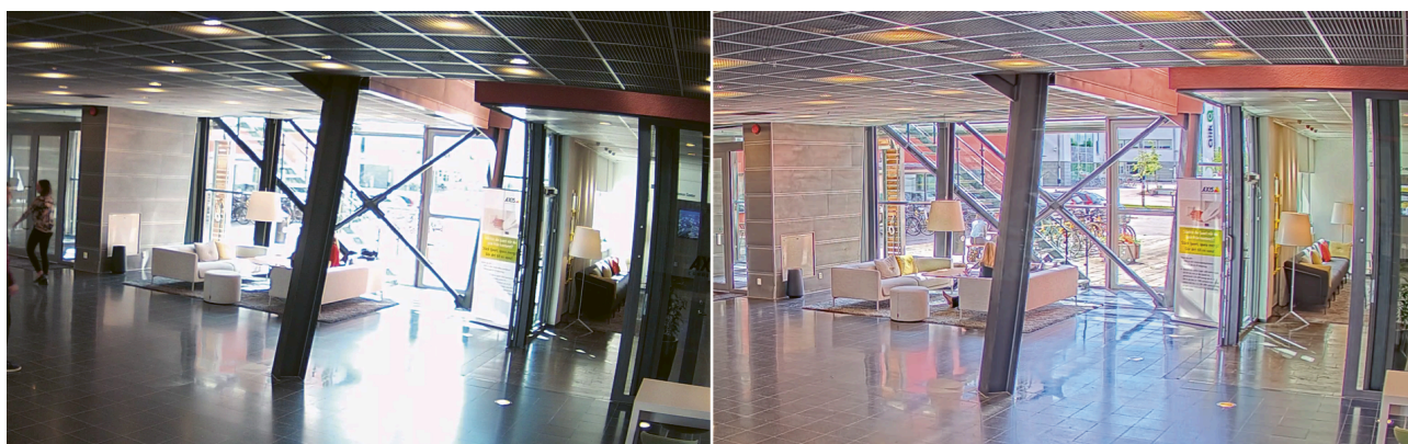
図 5.1 強い逆光がある屋内シーン。WDR機能非搭載カメラ (左側) とAxisのForensic WDR搭載カメラ (右側) で撮影した画像の比較。
