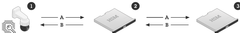
Figure 2. Infrastructure à clés publiques (PKI) IEEE 802.1AR Axis pour le provisionnement en usine de l'identifiant de périphérique Axis pendant le processus de fabrication. L'ID de dispositif Axis (1), qui est un certificat intégrant le numéro de série du produit, est signé par une CA intermédiaire d'ID de dispositif Axis (2), elle-même signée par la CA racine de l'ID de dispositif Axis (3). Des modules matériels de sécurité (HSM) spécialisés sont utilisés pour le provisionnement sécurisé en usine.
