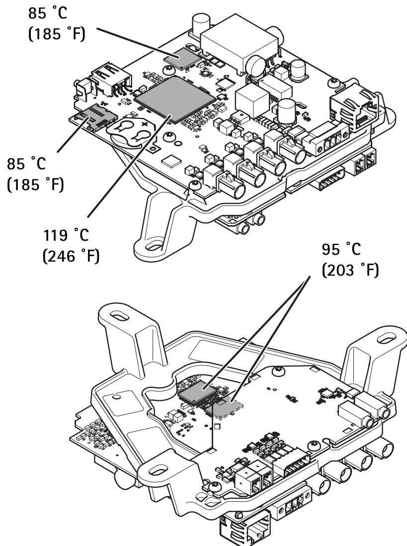
*Temperaturas máximas permitidas. Se a temperatura ambiente for  $35^{\circ}\text{C}$  ( $95^{\circ}\text{F}$ ) ou superior, a temperatura dos componentes aumentará e ela deverá ser resfriada.*
