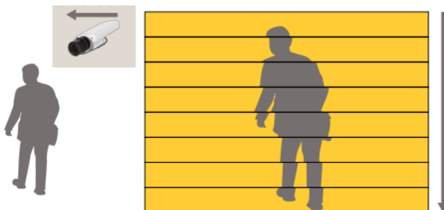
Figure 2. Il principio della distorsione da scansione lineare. Le righe vengono lette dal sensore dal lato superiore al lato inferiore dell'immagine. Quando la vibrazione fa spostare leggermente la telecamera a sinistra durante la lettura delle righe, il risultato è un'immagine distorta.
