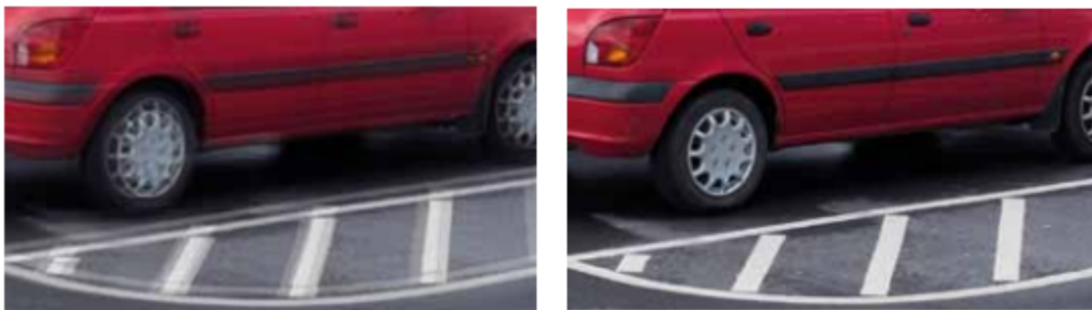
Figure 1. Immagini simulate. A sinistra: primo piano senza stabilizzatore elettronico dell'immagine. Si evidenzia la sfocatura da movimento orizzontale e verticale. A destra: istantanea della telecamera che vibra con lo stabilizzatore elettronico dell'immagine attivato.
