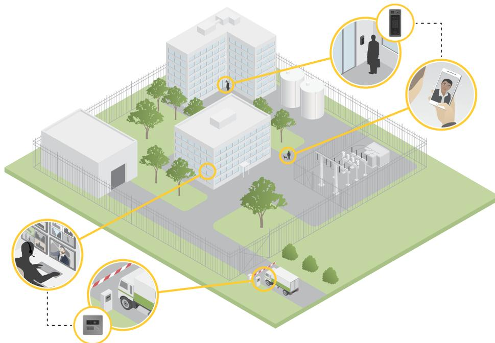
*Figure 1. Un intercomunicador con vídeo puede colocarse en la entrada de un espacio y conectarse a varias estaciones receptoras. Sin embargo, cuando se utilizan para aplicaciones de vigilancia, es más útil combinarlos con cámaras de red y otros dispositivos IP, todos conectados a un mismo punto de control.*
