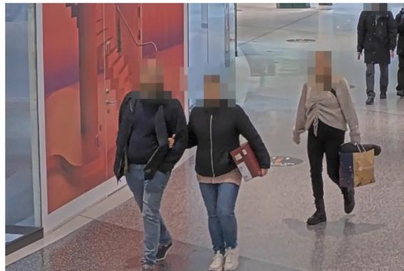
KI-basierte Maskierung wird in ausgewählten Kameras mit einer Deep Learning Processing Unit (DLPU) unterstützt. Mit der KI-basierten Maskierung können Sie Live-Videos auf menschliche Formen analysieren und entweder Menschen oder den Hintergrund maskieren. Diese Funktion ist für Innen- und Außenszenen im Nahbereich geeignet.
