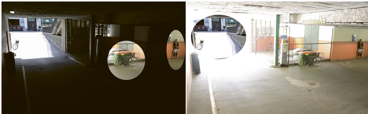
Figure 2. 上の画像と同じシーン。左側の画像は短い露出時間ではキャプチャーされなかった詳細を示しています。右側の画像は長い露出時間ではキャプチャーされなかった詳細を示しています。
