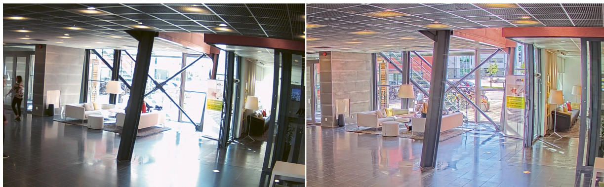
Figure 3. 強い逆光がある屋内シーン。WDR機能非搭載カメラ (左側) とAxisのForensic WDR搭載カメラ (右側) で撮影した画像の比較。
