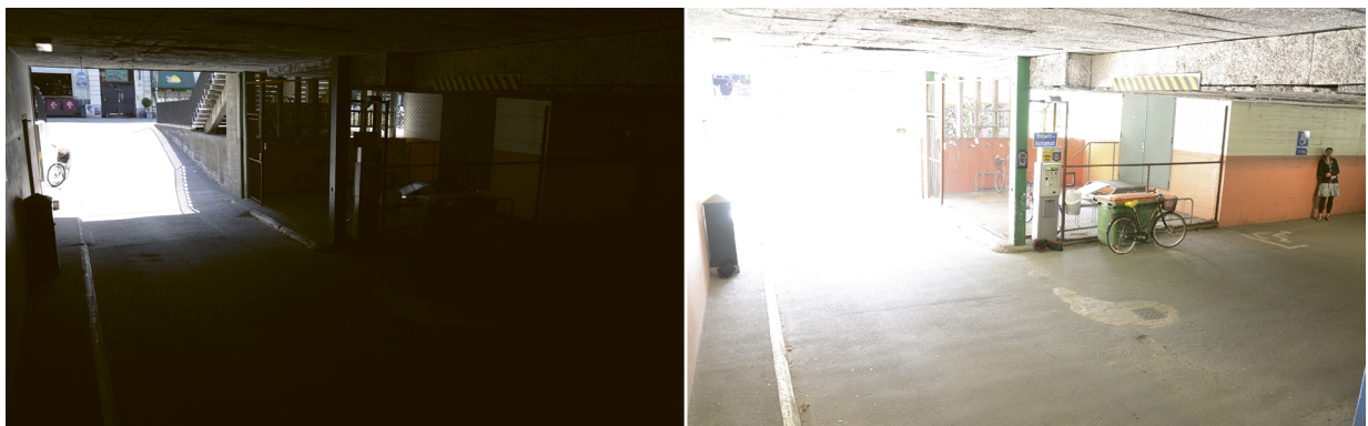
Figure 1. ダイナミックレンジが広い典型的な監視シーン: エントランスがあるパーキングガレージの屋内。この2つの画像は、異なる露出時間を使用して撮影されています。左側が露出時間の短い画像、右側が露出時間の長い画像です。
