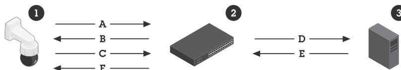
Figure 8. 更详细的配置入网说明。用于安全设备身份识别的IEEE 802.1AR定义了一种方法，旨在利用RADIUS服务器 (3)，通过IEEE 802.1X可扩展身份验证协议请求 (EAP-TLS) 来识别设备 (1)，从而获取设备对网络的访问权限。
