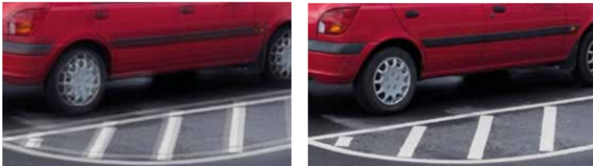
Figure 1. Obrazy symulowane. Po lewej: zbliżenie bez elektronicznej stabilizacji obrazu, z widocznym rozmyciem obrazu w poziomie i w pionie. Po prawej: zdjęcie z drgającej kamery z elektroniczną stabilizacją obrazu.
