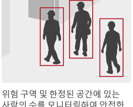
위험 구역 및 한정된 공간에 있는 사람의 수를 모니터링하여 안전한 수용 한계를 준수하지 않을 경우 오디오 경고를 발령합니다.
