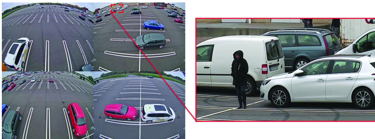
Видеонаблюдение за автостоянкой с использованием режимов просмотра: всенаправленной камеры с PTZ. Квадрированный обзор на 360° и увеличенное изображение с PTZ-камеры.
