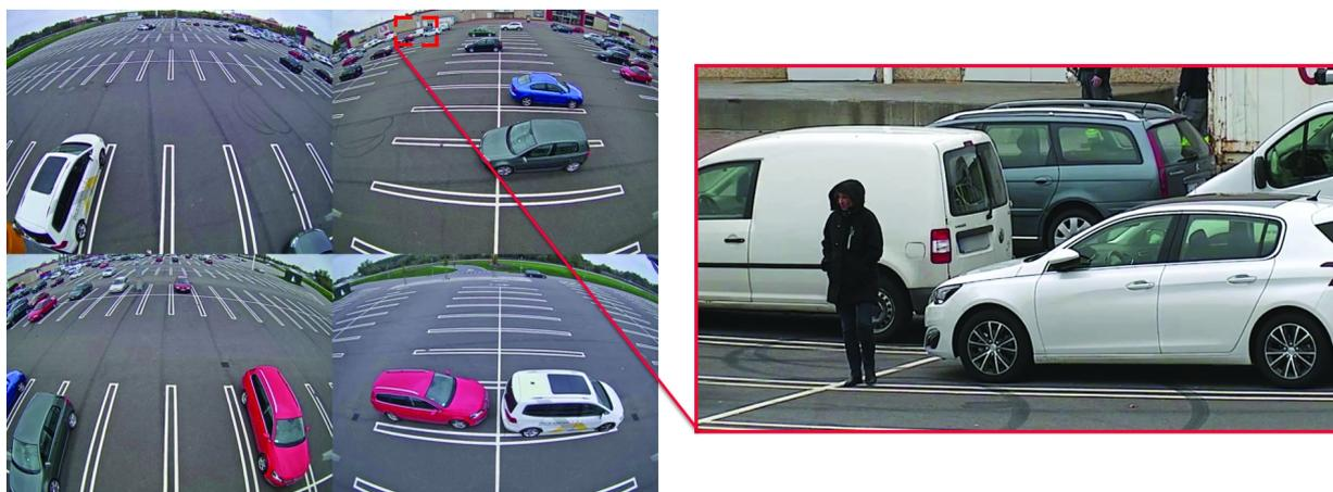
*Parkplatzüberwachung mit einer Mehrrichtungskamera mit PTZ. 360°-Vierfachansicht und vergrößerte PTZ-Ansicht.*
