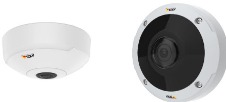
Eine Einzelsensorkamera hat ein Weitwinkelobjektiv, das eine kreisrunde 360°-„Fischaugen“-Ansicht des Überwachungsbereichs liefert. Die Kamera ist klein, unauffällig, erschwinglich und ohne Weiteres an einer Decke oder Wand zu platzieren. Bei Deckenmontage kann sie einen Überblick über den gesamten Raum bieten. Dabei beseitigt sie wirksam alle toten Winkel etwa in einem kleinen Einzelhandelsgeschäft. Wird sie
