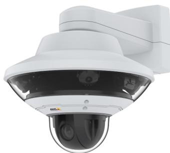
Eine Mehrrichtungskamera mit PTZ ist eine Kombination aus einer 360°-Mehrrichtungskamera und einer motorisierten PTZ-Kamera, die zu einer Einheit verbaut sind. Die Mehrrichtungskamera bietet einen vollständigen Überblick, und die PTZ-Kamera liefert scharfe und detaillierte Nahaufnahmen mit hohem forensischem Wert, die über ein einziges Netzkabel gespeist und gesteuert werden.
