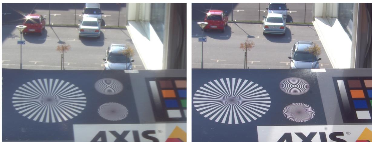
*A foto à esquerda foi tirada com uma câmera usando uma lente DC-iris. A foto à direita foi tirada com uma câmera usando uma lente P-Iris e exibe um contraste mais nítido do que a foto à esquerda.*
