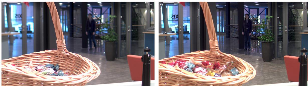
*A foto à esquerda foi tirada com uma câmera usando uma lente DC-iris. A foto à direita foi tirada com uma câmera usando uma lente P-Iris e exibe uma profundidade de campo maior do que a foto à esquerda.*
