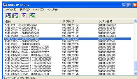
AXIS Q1755 は、AXIS IP Utility が動作しているコンピュータと同じネットワークセグメント（物理サブネット）にインストールする必要があります。
