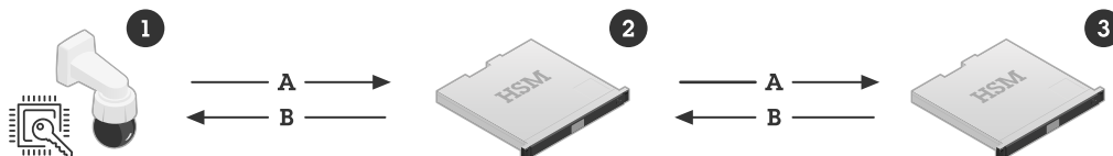
Figure 2. Infrastruttura a chiave pubblica (PKI) IEEE 802.1AR per creare l'ID dispositivo Axis durante la produzione. L'ID dispositivo Axis (1), che è un certificato che incorpora il numero di serie del prodotto, è firmato da un CA intermedio dell'ID dispositivo Axis (2), firmato precedentemente dal CA radice dell'ID dispositivo Axis (3). Per il provisioning sicuro in fabbrica vengono utilizzati moduli di sicurezza hardware dedicati (HSM).
