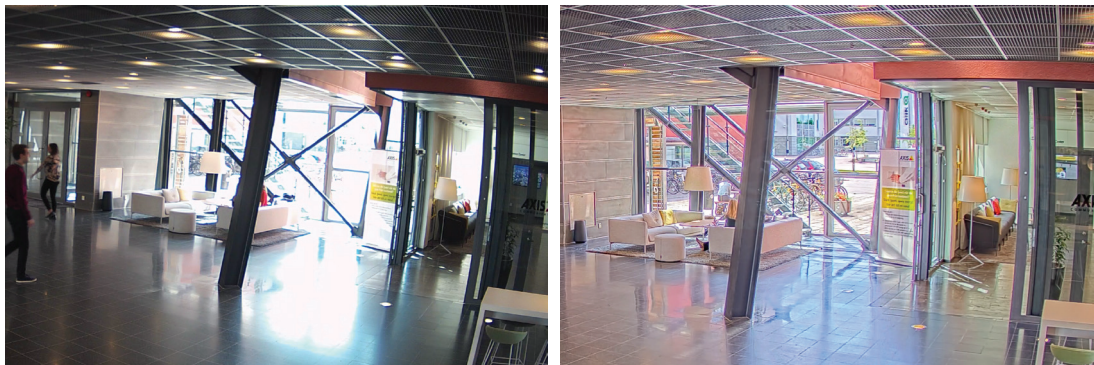
Рисунки 5 и 6. Помещение с сильным контрастным светом. Сравнительное качество изображений с обычной сетевой камеры без функции широкого динамического диапазона (слева) и с камеры Axis с функцией Forensic WDR (справа).
