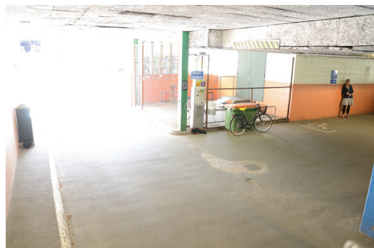
Рисунки 1 и 2. Типичный кадр камеры видеонаблюдения с широким динамическим диапазоном — гараж с въездом. Съемка двух изображений выполнялась с разной выдержкой: меньшей для кадра слева и большей для кадра справа.
