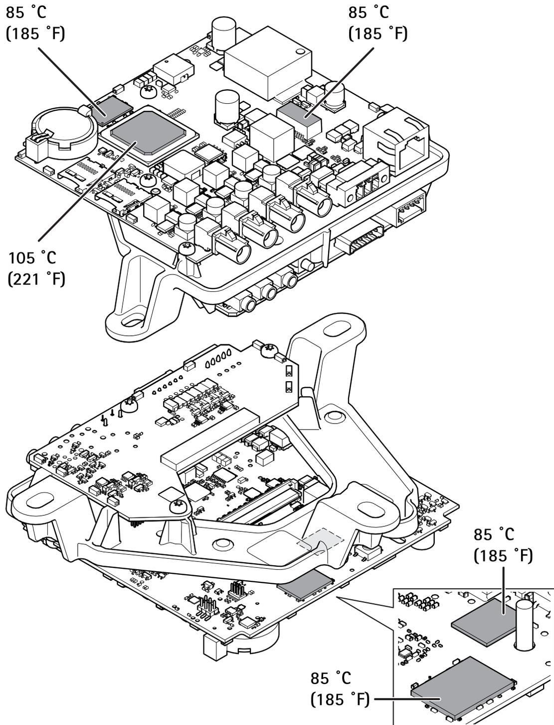
*Temperature massime consentite. Se la temperatura ambiente è di 35 °C o superiore, la temperatura dei componenti aumenta e devono essere raffreddati.*
