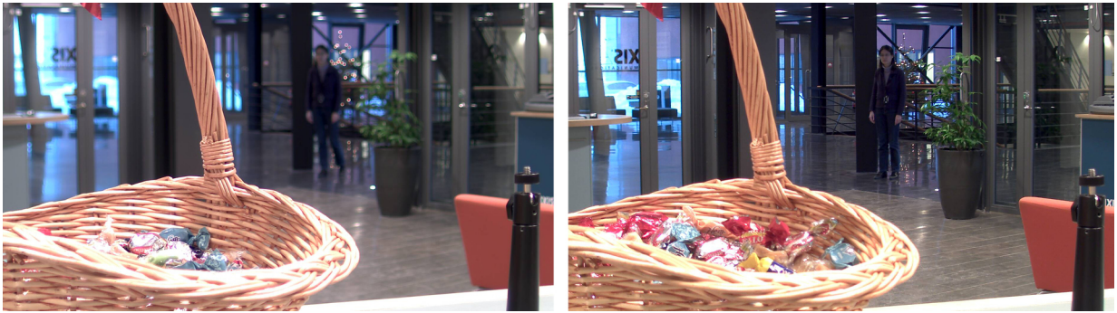
左图采用直流驱动光圈 (DC-Iris) 镜头拍摄。右图采用精确光圈 (P-Iris) 镜头拍摄，景深比左图更大。
