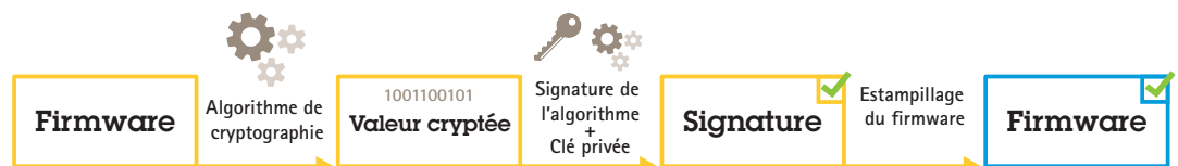
Schéma 1. Le processus de signature de firmware.
