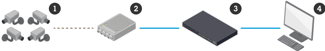
Figure 1. 아날로그 카메라(1)는 기존 동축 케이블을 사용하여 비디오 엔코더(2)와 연결합니다. 비디오 엔코더가 영상을 디지털화하여 LAN을 통해 네트워크 스위치(3)에 전송하면, 네트워크 스위치가 영상 관리 소프트웨어(VMS)(4)에 영상을 전송합니다.
