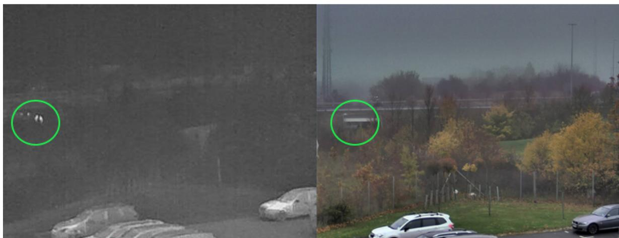
雨の日に撮影されたサーマルカメラ(左)と可視光カメラ(右)の画像。サーマルカメラでは、人(丸で囲んだ部分)を簡単に識別できます。
