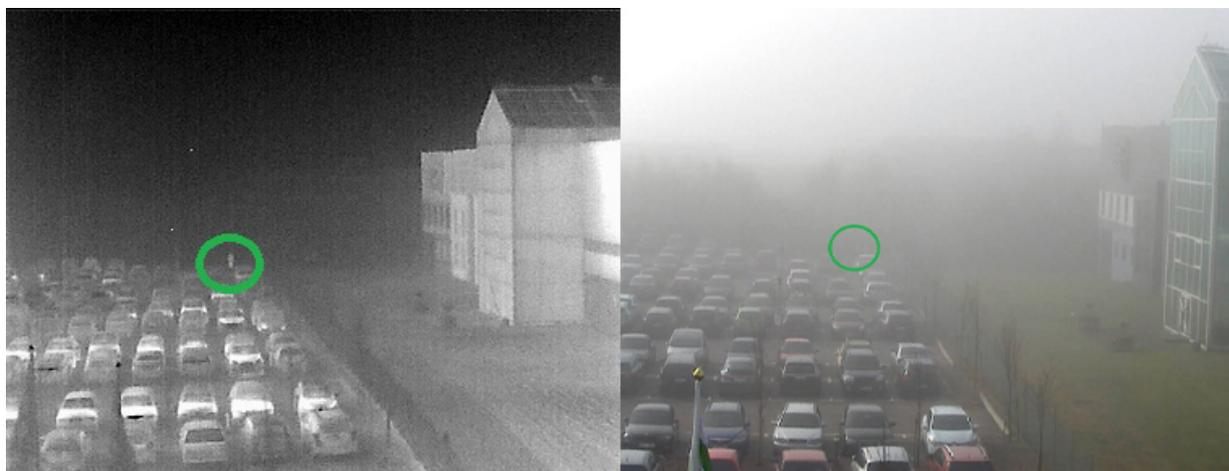
霧の日のサーマルカメラ(左)と可視光カメラ(右)の画像。サーマルカメラでは人(丸で囲んだ部分)を識別できますが、可視光カメラでは識別できません。
