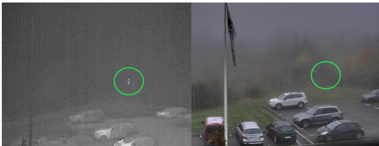
霧の日に撮影されたサーマルカメラ (左) と可視光カメラ (右) の画像。サーマルカメラでは人 (丸で囲んだ部分) を識別できますが、可視光カメラでは識別できません。
