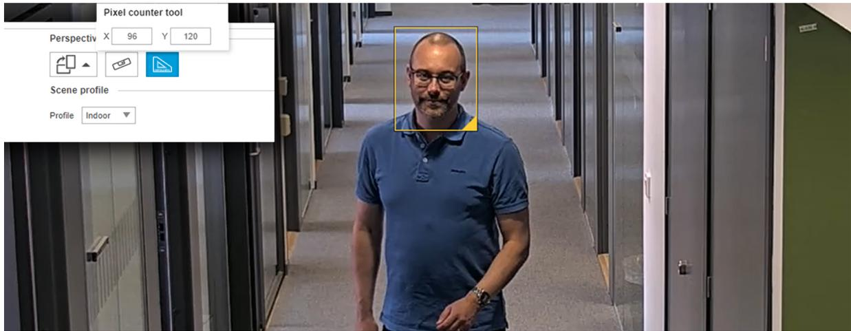
Figure 4. 픽셀 카운터가 표시되는 카메라 영상. 이 도구는 프레임 전체에 96픽셀이 있음을 보여주므로 식별이 가능하다는 것을 보여줍니다(얼굴 전체에 최소 40픽셀 필요).
