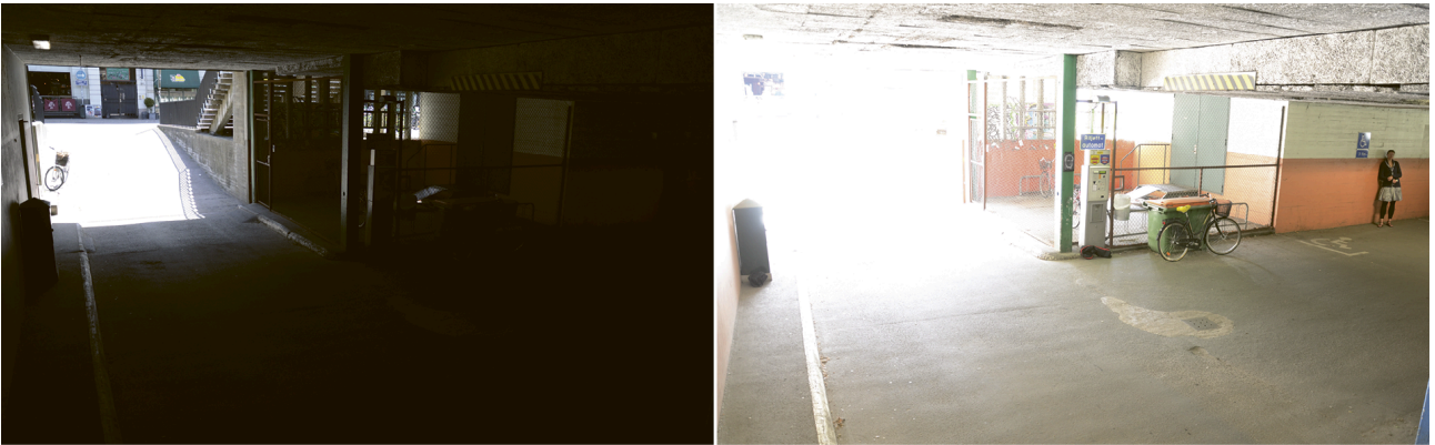
그림 2.1 광역 역광 보정(WDR)을 통한 일반적인 감시 장면: 주차장 내부와 입구. 두 이미지는 노출 시간을 다르게 해서 촬영했으며 왼쪽은 노출 시간이 짧은 이미지이고 오른쪽은 긴 이미지입니다.
