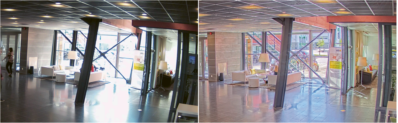
그림 5.1 강한 역광 상태의 실내 장면. WDR 기능이 없는 카메라(왼쪽)와 Forensic WDR 기능이 있는 Axis 카메라(오른쪽) 간 비교.
