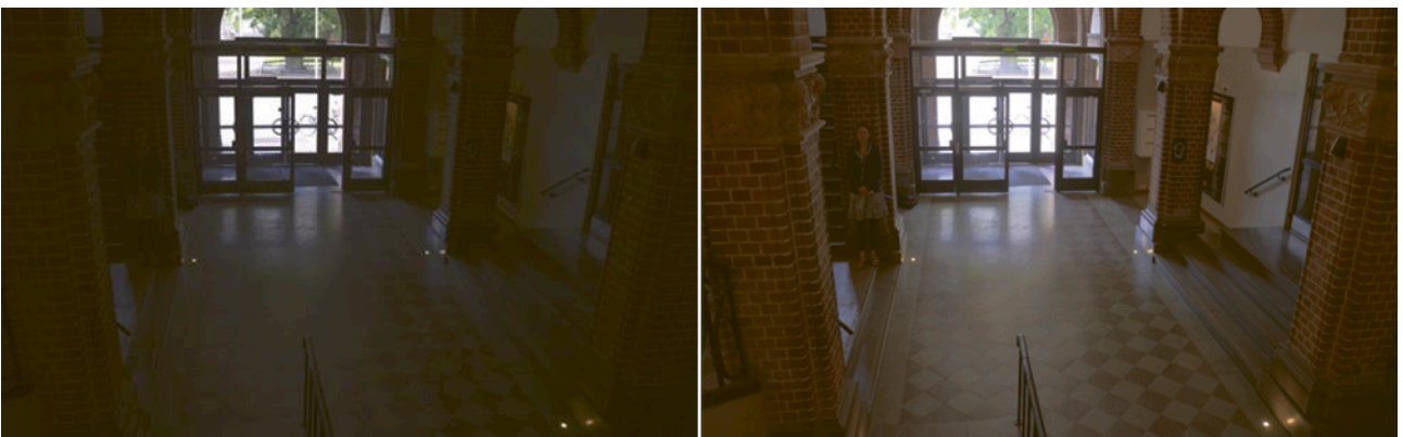
그림 6.1 다른 dB 값의 카메라로 캡처한 역광 상태 실내. 예상과 달리 오른쪽 이미지가 왼쪽 이미지보다 지정된 dB 값이 낮은 카메라로 촬영한 이미지입니다.
