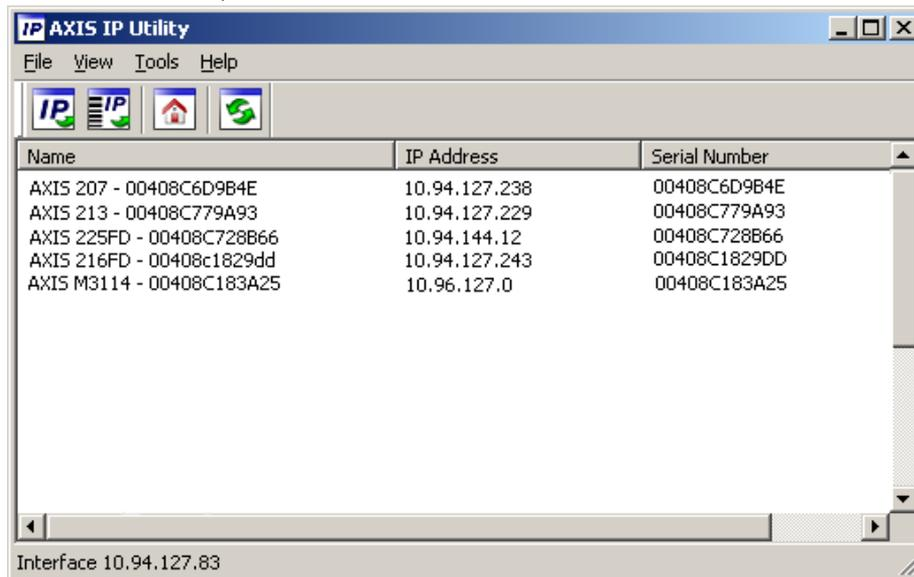
ネットワークカメラは、AXIS IP Utility が動作しているコンピューターと同じネットワークセグメント (物理サブネット) 上にインストールする必要があります。
