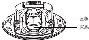
光学ホルダーの底部内側の直線を光学マウントの中央の直線に揃えます。
