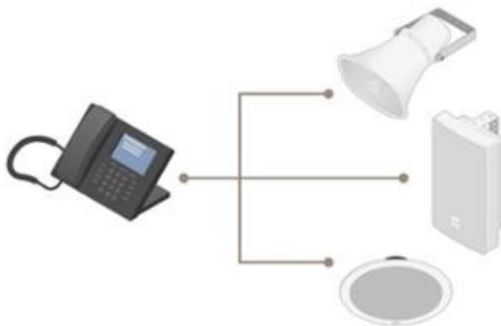
Большинство современных офисных телефонов поддерживают протокол SIP. С IP-аудиоустройством Axis можно соединиться со стандартного SIP-телефона, просто набрав соответствующий SIP-адрес.
