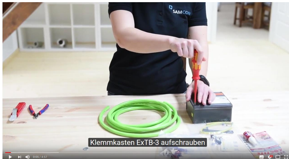
Илл. 5-4 Видео-учебник ExTB-3: отвинчивание клеммной коробки ExTB-3
