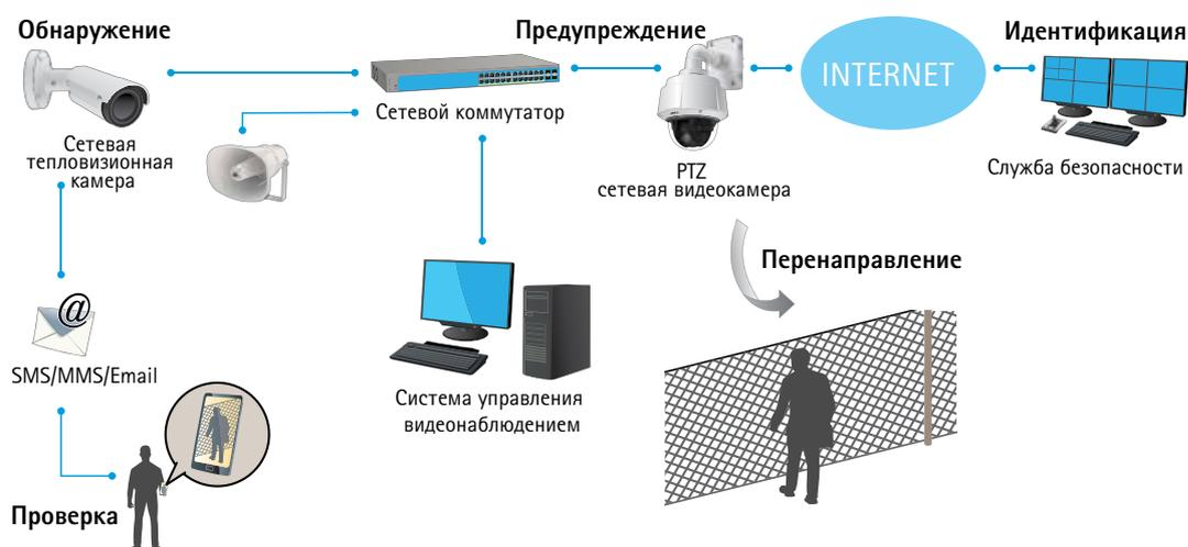
Рис. 1. Тепловизионная сетевая камера Axis в составе системы защиты периметра.
