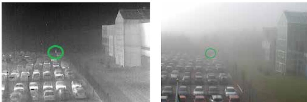
Рис. 3 Изображение с тепловизионной камеры (слева) и обычной видеокамеры (справа) в туманный день.
