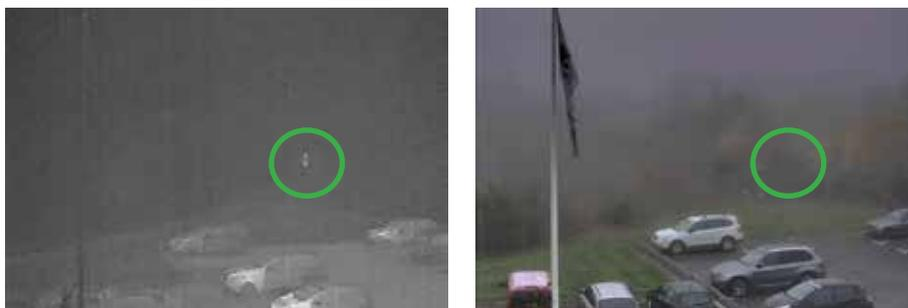
Рис. 4. Кадры человека, сделанные тепловизионной камерой (слева) и обычной видеокамерой (справа) при сильном тумане
