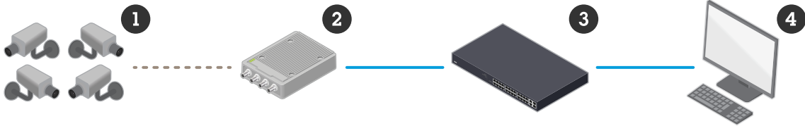
Figure 8. 这是一种通过IP网络持续传输视频的网络视频系统。它使用视频编码器 (2) 作为基础 (同时使用网络交换机 (3) 和安装有VMS的计算机 (4)) 将模拟安防系统迁移到开放式基于IP的视频解决方案。
