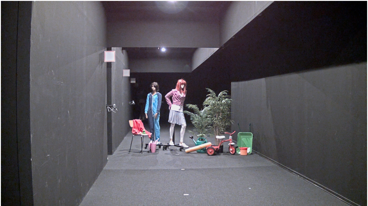
Figure 4. 1.5 lux (세발자전거)와 5 lux (마네킹의 허리 높이) 사이의 조명 강도를 가진 스튜디오 장면. Lightfinder 카메라는 선명한 색상과 믿을 수 없을 정도로 밝은 이미지를 제공했습니다. 사람의 눈도 색상을 식별할 수 있지만 장면이 매우 어둡게 인식됩니다.
