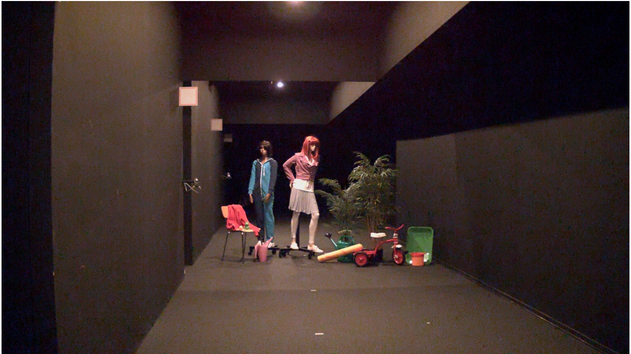
Figure 5. 객체 상의 조도 0.2 lux - 0.7 lux. Lightfinder 카메라는 밝은 색상을 제공합니다. 사람의 눈에는 색감이 확실하지 않았고, 디테일이 거의 없이 주로 밝은 표면을 구별할 수 있었습니다.
