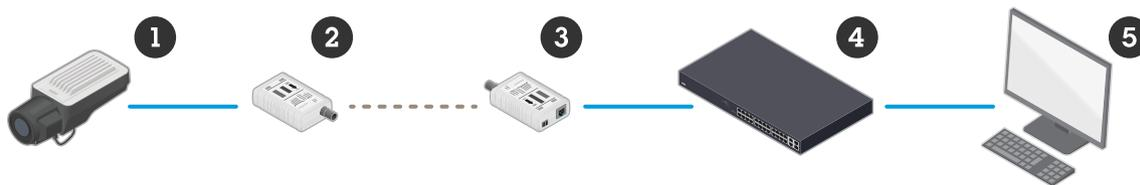
*Figure 9. Un sistema de vídeo en red que utiliza un kit adaptador de PoE+ a través de cable coaxial (adaptador de dispositivo [2] y adaptador de base [3]) para combinar las cámaras IP (1) y el cableado coaxial existente. El sistema se conecta a la red y a un VMS por medio de un switch de red (4) y un ordenador (5).*
